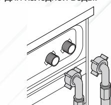
**ПРЕДУПРЕЖДЕНИЕ:** При установке машины следите за тем, чтобы подсоединения к кранам холодной и горячей воды были выполнены правильно. Иначе по окончании стирки белье будет горячим, что приведет к его быстрому износу.
